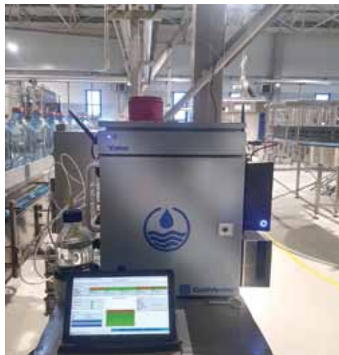
Abb. 3 Überwachung der mikrobiologischen Qualität der Quellwasserzuleitung bei Romaqua, Rumäniens größtem Mineralwasserabfüller
